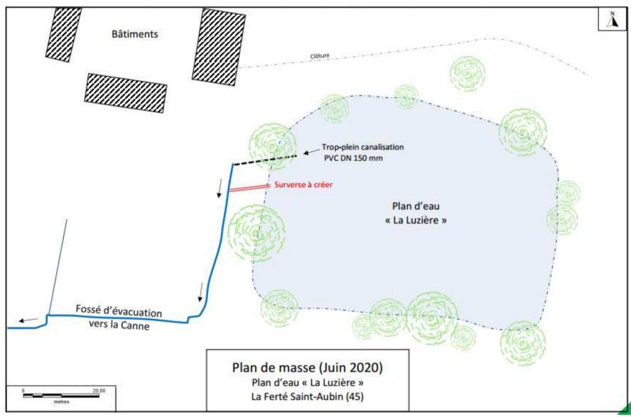
ANNEXE 3 : Plan détaillé de l'écoulement d'évacuation vers la Canne
